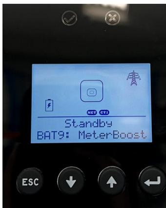
7. A mensagem **Set OK !** irá aparecer no ecrã e o inversor irá reiniciar. A configuração do inversor está terminada e o inversor está pronto para funcionar com as baterias da MeterBoost.
